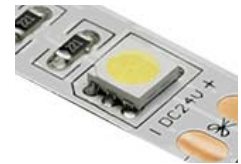
5050 : 1 puce blanc chaud ou blanc froid de 0.24w/led Forte luminosité
