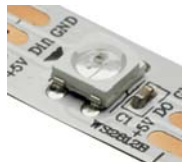
WS2812B : 3 puces RGB de 0.24w/led avec circuit de commande intégré Chaque LED peut être pilotée indépendamment
